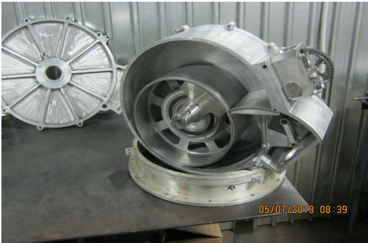
Рис.1. Фотография 100 кВт-ного блока роторно-поршневой паровой машины - двигателя электрогенератора.
